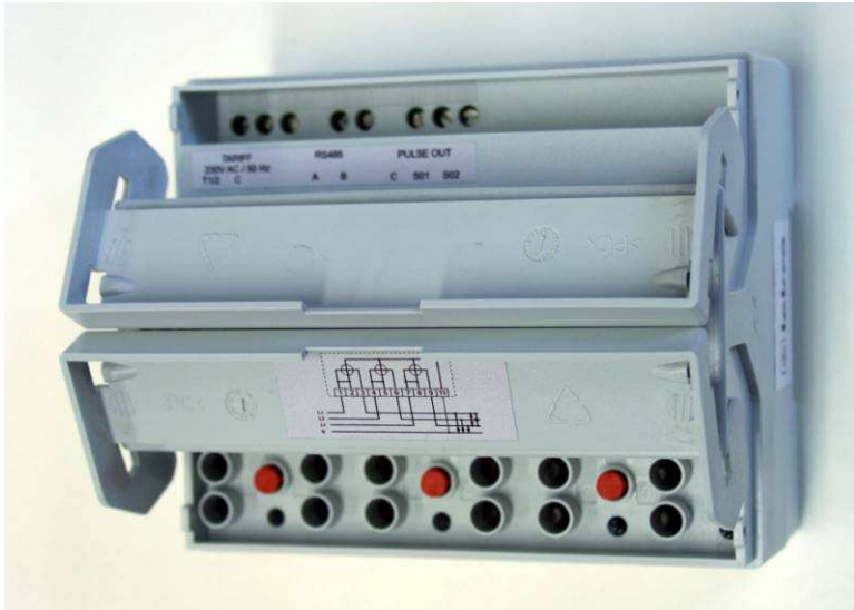
Bild 12: WS0302 mit geöffneter Klemmenabdeckung
